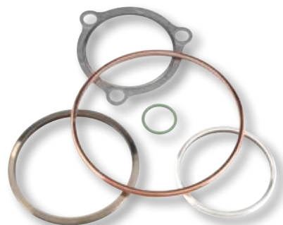
>> 高压密封用的C型金属密封件和E型金属密封件 问题： 蒸汽轮机壳体泄漏。 解决方案： 派克弹簧增压C型金属密封件和预压缩E型密封件。 派克的优势： 派克金属密封件利用护套力量、弹簧力量、静液压力来增强压力，进而为密涡轮外壳提供密封，可承受高达95,000psi (6,550bar)的压力，具有优良的耐腐蚀性和抗疲劳性。
