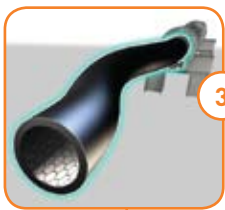
耐磨CERGOM 10软管 我们软管的寿命是钢管的34倍，是真空输送煤炭粉末和浆液系统的理想选择。派克将新的软管材料与陶瓷板材相结合，并且在陶瓷板材中嵌入了添加有人工合成纺织品的复合橡胶。
